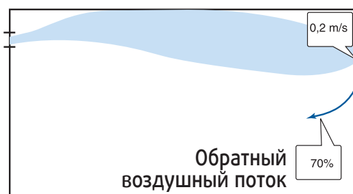
Рис. 15. Обратный воздушный поток при установленном на стене диффузоре
