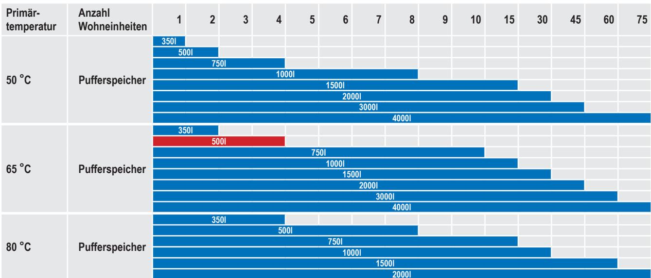
Grundlage je Wohneinheit: Zapfmenge 12 l/min bei 45 °C, Zapfdauer 10 min, bei Heizgeräten (Öl/Gas/Holz), bei Wärmepumpe x 2
