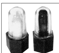
Индикатор сигнального анода. Слева: не отработанный – белый Правый: отработанный – красный
