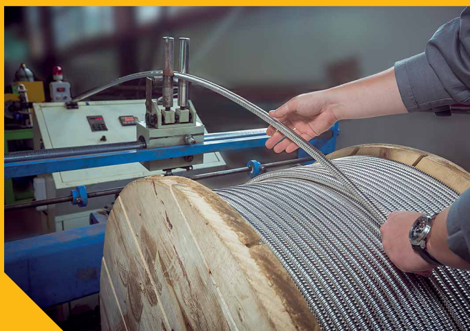
Подача гофрированной трубы Stahlmann для отжига
