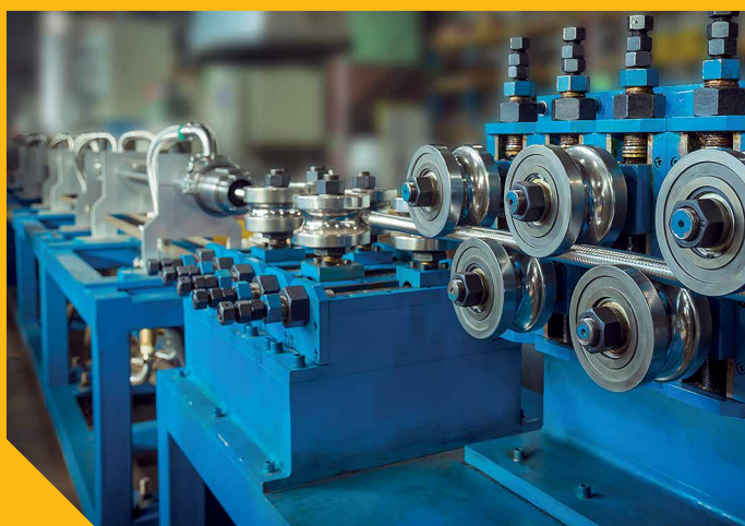
Линия охлаждения гофрированной трубы Stahlmann после отжига
