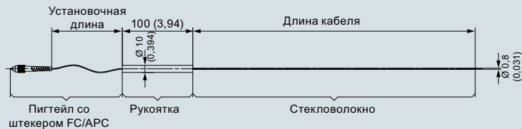
Измерительный зонд с разъемом FC/APC, пигтейлом и рукояткой; размеры в мм (дюймах)
