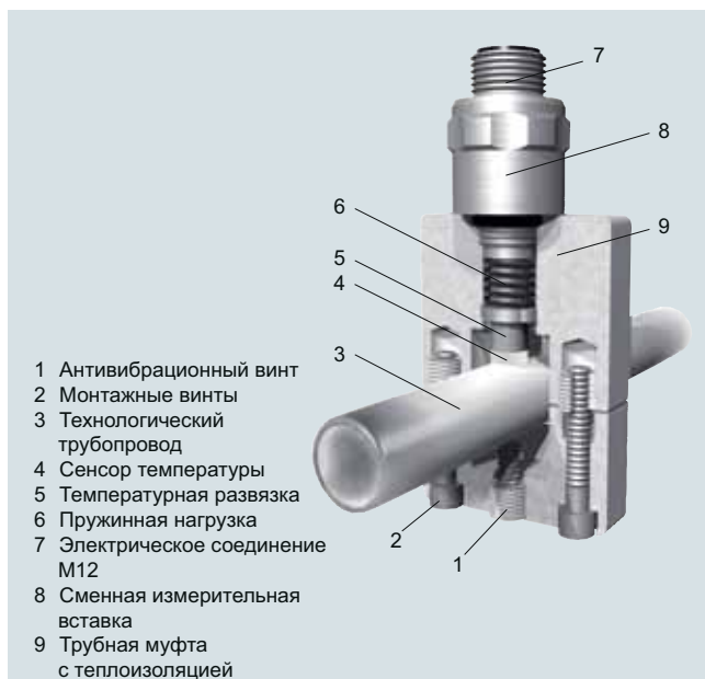
Термометр сопротивления с защитной трубкой в накладном исполнении
