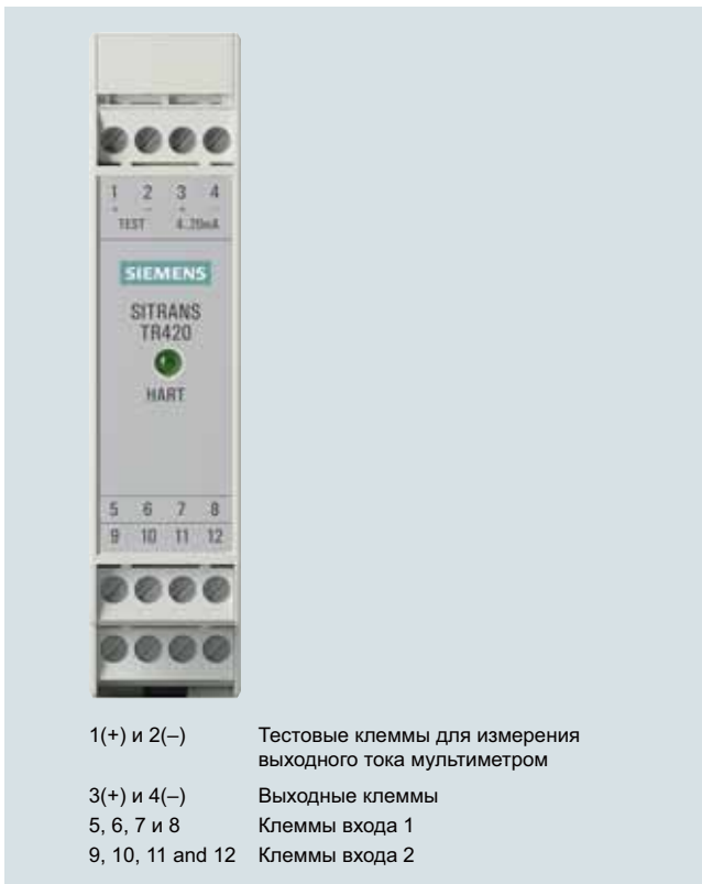
SITRANS TR420, назначение разъемов
