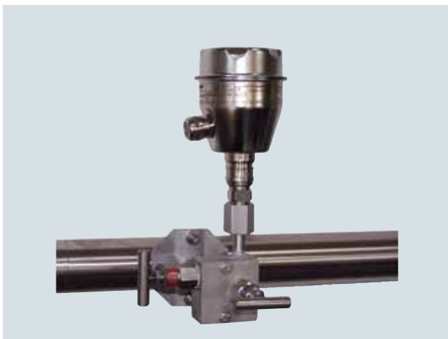
Вентильный блок 7MF9011-4EA, смонтированный на измерительных преобразователях избыточного и абсолютного давления
