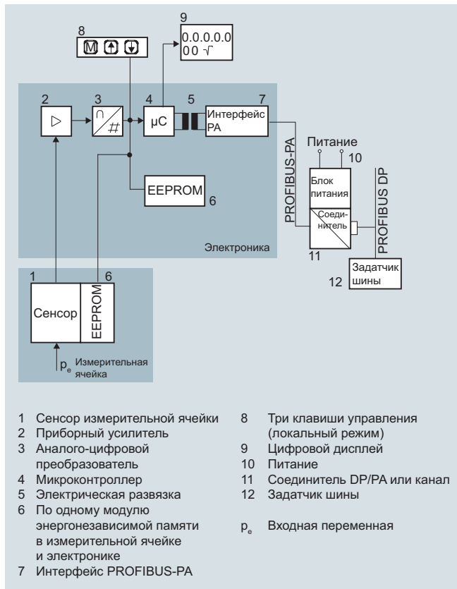
Функциональная схема электроники
