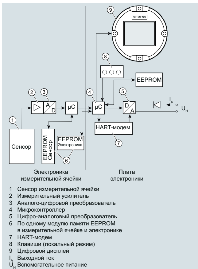
Измерительная ячейка для дифференциального давления и расхода, функциональная схема
