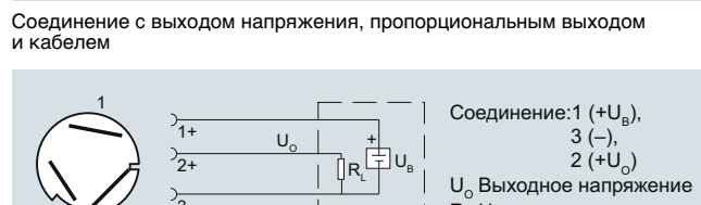
Соединение с выходом напряжения, пропорциональным выходом и быстроразъемным кабельным резьбовым соединением Quickon
