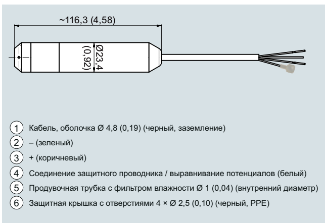
Измерительный преобразователь давления SITRANS LH100, размеры в мм (дюймах)
