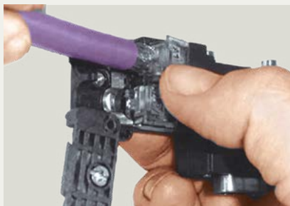
Зачистка и сборка с помощью разъема с проколом изоляции
