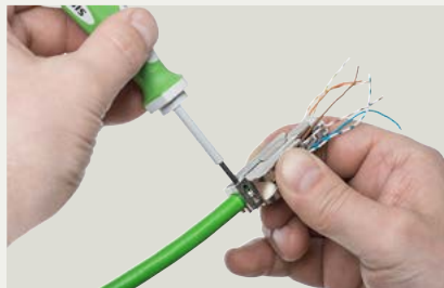
Закрепите корпус с помощью отвертки
