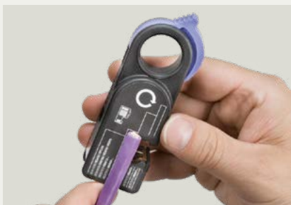
Зачистка и сборка с помощью M12 разъема
