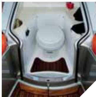
Sanimarín соединен с баком для сбора сточных вод
