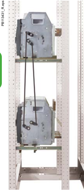
Блокировка двух выключателей MasterPact NT или NW соединительными штангами
