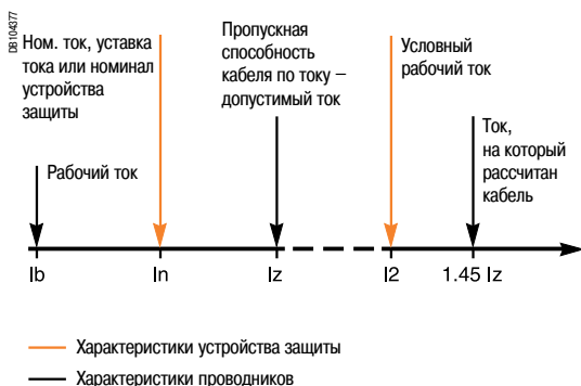
Токи в электропроводке, защищенной предохранителем
