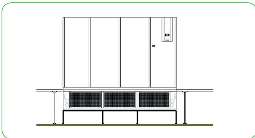
Агрегат с отсеком вентиляторов, установленным под фальшполом.
