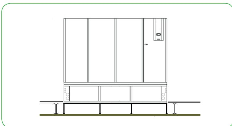
Агрегат с отсеком вентиляторов, установленным над фальшполом.
