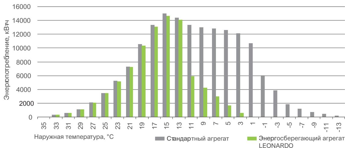
Сравнение годового потребления энергии стандартным агрегатом и агрегатом без системы естественного охлаждения (условия в помещении: 24 °C, относительная влажность 50 % при постоянной нагрузке, TDER1822A + 2 x RAL3600 – Франкфурт)
