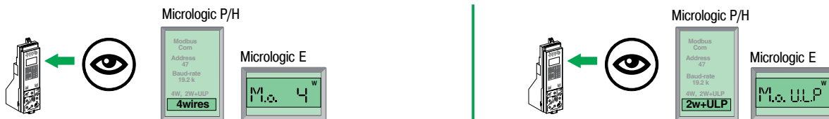
A Modbus RS 485 (4 провода) без модуля ULP
