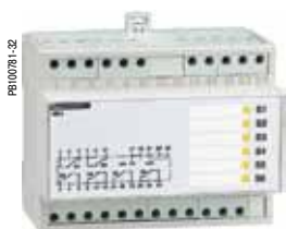
Контакты M6C: реле, расположенное вне выключателя, с 6 независимыми переключающими контактами, управляемыми от выключателя через 3-проводное соединение
