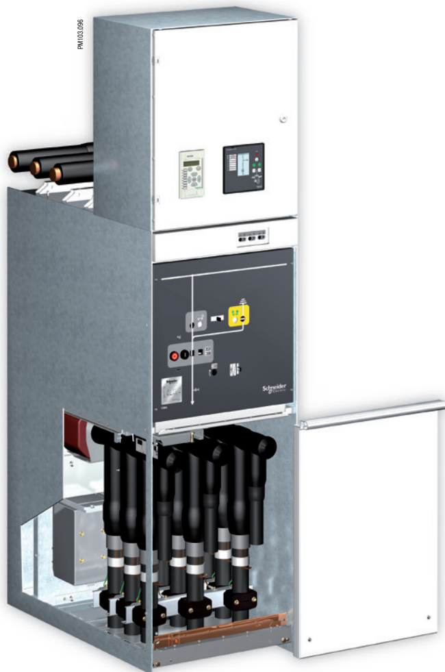
Ячейка шириной 600 мм, с трансформаторами напряжения, 3 кабеля на фазу + разрядник На рисунке показана ячейка на токи до 1250 А
