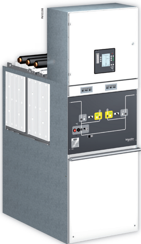
Ячейка шириной 1000 мм с силовым выключателем и встроенным заземлителем системы сборных шин На рисунке показана ячейка на токи до 2000 А
