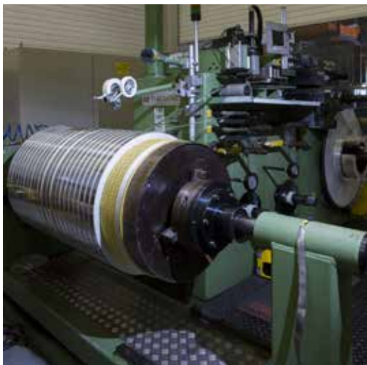
Обмотка ВН, изготавливаемая из металлической ленты
