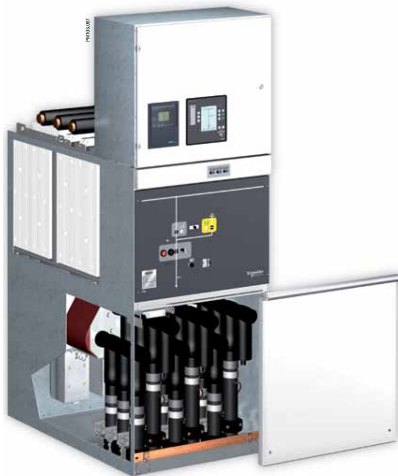
Ячейка шириной 800 мм, с трансформатором напряжения, подключены 4 кабеля (сдвоенный конус), с разрядником На рисунке показана ячейка на токи 2000 А
