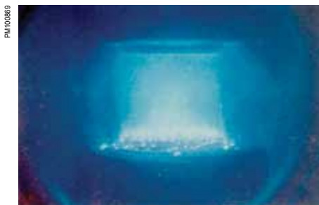
Рассеивание электрической дуги между разомкнутыми контактами АМП
