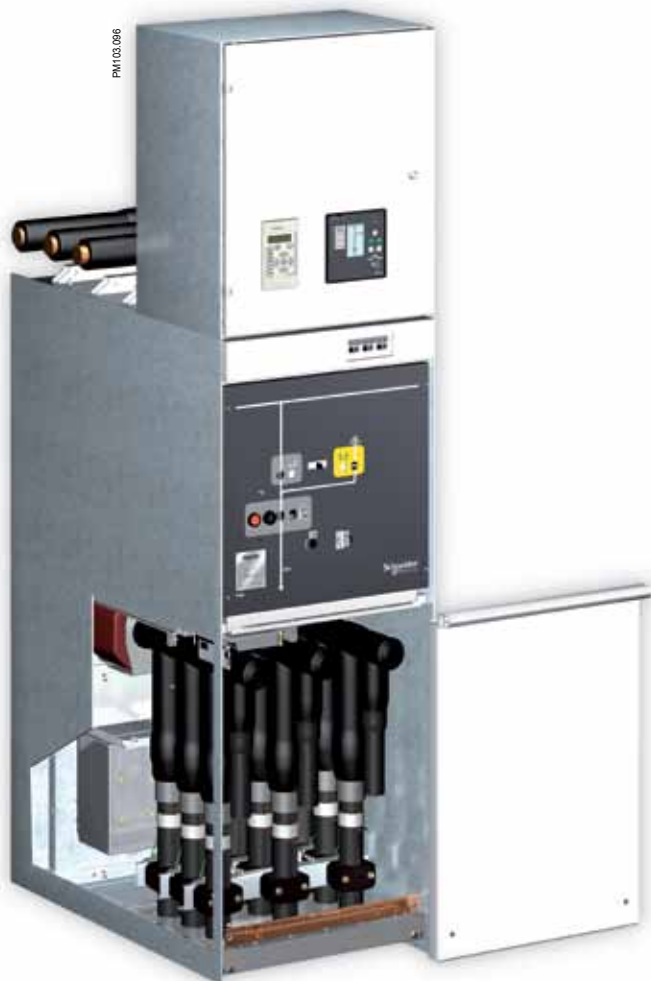
Ячейка шириной 600 мм, с трансформаторами напряжения, подключение кабелей 3 фаз, с разрядником На рисунке показана ячейка на токи до 1250 А
