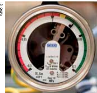
Манометр со вспомогательным контактом
