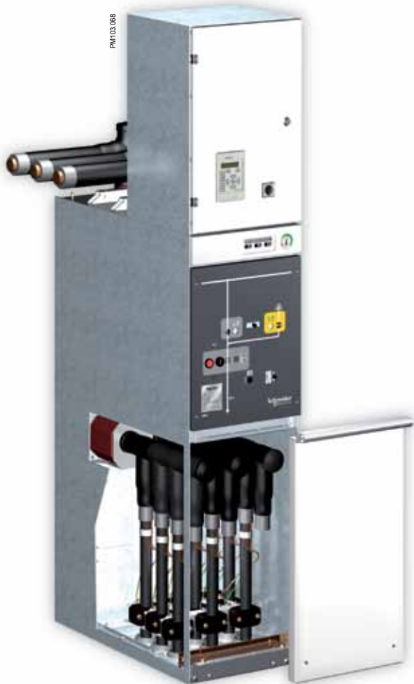
Ячейка шириной 450 мм, подключение кабелей 3 фаз, с разрядником На рисунке показана ячейка на токи до 800 А
