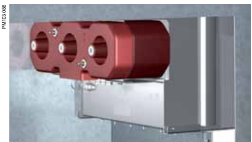
Блок трансформаторов тока с дополнительным сердечником на кабельном присоединении, ширина ячейки 600 мм
