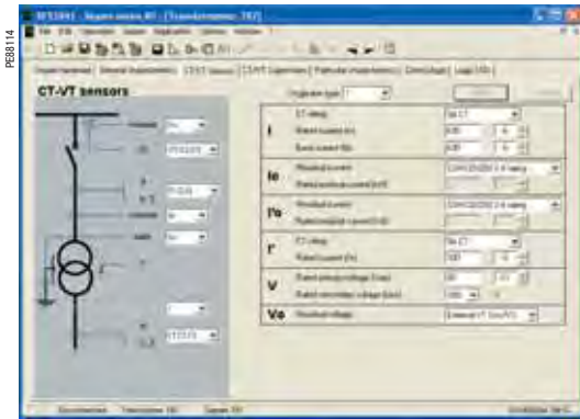
Пример экрана программного обеспечения SFT2841: настройка параметров датчиков Sepam серии 80
