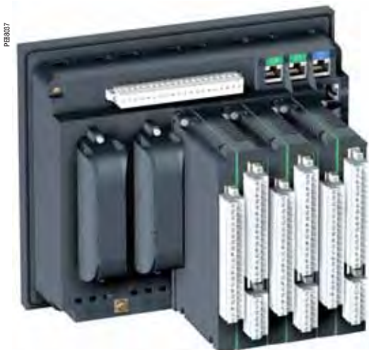
Максимальная конфигурация Серват серии 80 с 3 модулями MES120: 42 входа и 23 выхода
