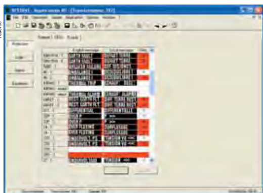
Пример экрана программного обеспечения SFT2841: матрица управления
