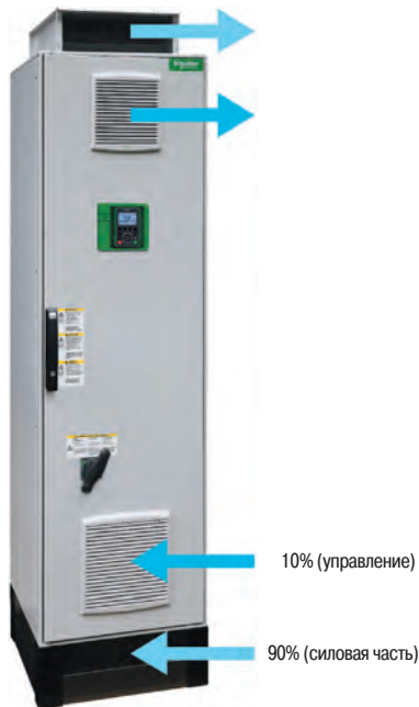
Система охлаждения с разделением потоков воздуха
