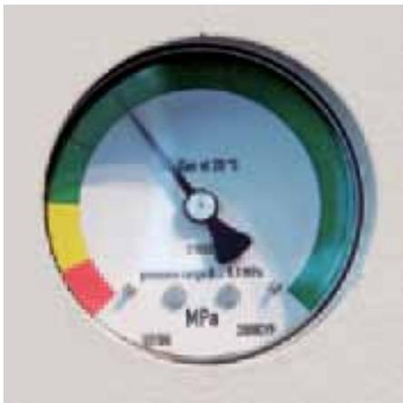
Манометр как индикатор эксплуатационной готовности (базовое исполнение)
