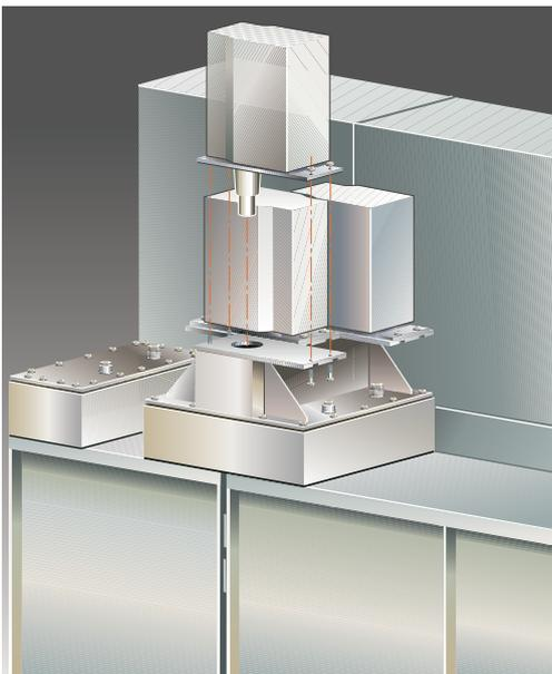
Вставные трансформаторы напряжения на сборной шине без дополнительного секционирования ячейки
