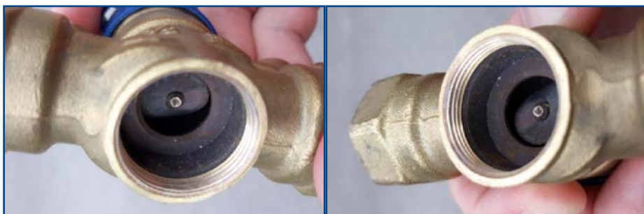
Пример повреждения уплотнения запорного золотника.
