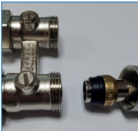
Уплотнение фитинга арт. 4937 должно выступать не менее чем на 3 мм, относительно края радиаторной трубки.
