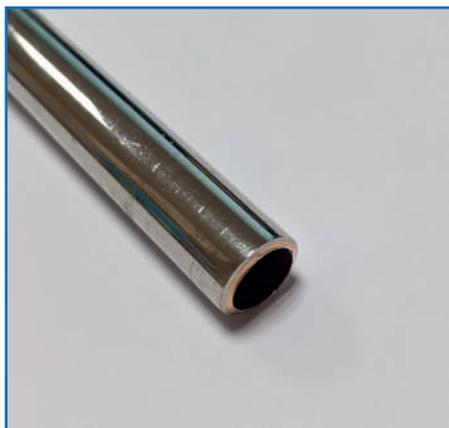
Угол отреза трубок должен составлять  $90^\circ$ , не иметь заусенцев, неровных краев, деформаций.
