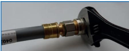
Требуется избегать избыточного усилия при затягивании накидной гайки, выбирать ключи переменного размера, соответствующие по номеру-диаметру соединения. Усилие затяжки должно быть дозированным, не рекомендуется прилагать чрезмерных усилий.
