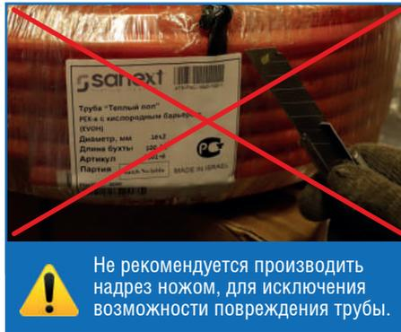
На этикетке бухты указано: наименование изготовителя, тип трубы, основные характеристики, на маркировке трубы указаны: метровая отметка, счётчик метров, логотип, структура трубы, SDR, наружный диаметр и толщина стенки, класс эксплуатации, рабочая температура и давление, регламентирующий стандарт, номер партии, дата и время производства. Перед размоткой и монтажом труб необходимо проверить соответствие их параметрам эксплуатации.
