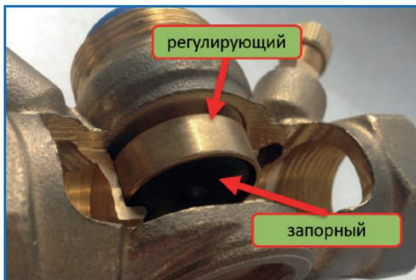
Запорный золотник имеет дополнительное уплотнение (EPDM), которое обеспечивает герметичность при кратковременном перекрытии потока. При этом следует отметить, что повреждение данного уплотнения возможно при попадании постороннего предмета/окалины.
