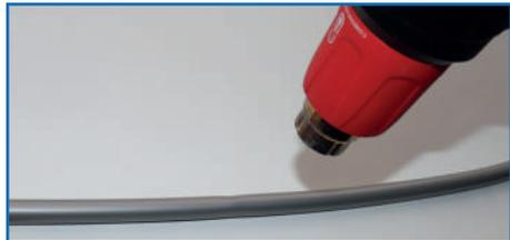
В случае залома, допустимо применить способ восстановления формы трубы при помощи нагрева
