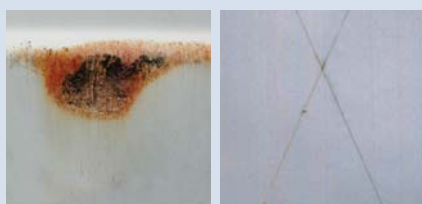
Обычный материал кожуха через 600 часов Антикоррозионный материал кожуха кондиционера Samsung через 1000 часов
