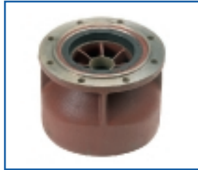
Диффузор полуаксиального насоса из чугуна с кольцом и втулкой из износостойкой резины. Cast iron diffuser of semi-axial pump, complete with ring and wearing bushing in antifriction rubber.
