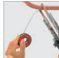
Нагрев места пайки без использования пламени
