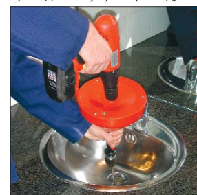
Привод от аккумуляторной дрели
