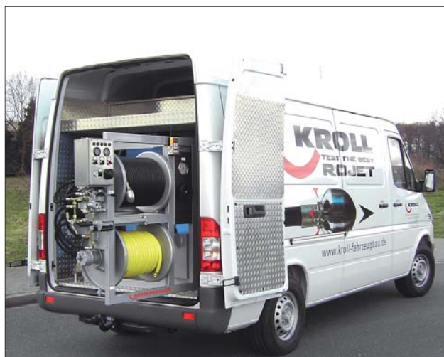
Комфортное исполнение - поворотный держатель для барабана
