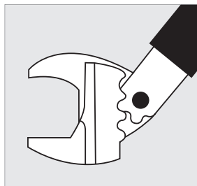
Головка ключа в полностью открытом состоянии
