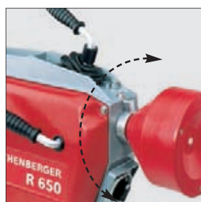
Приводной рычаг переставляется
