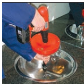
Привод от аккумуляторной дрели
