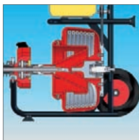
Защита спирали благодаря принудительному направлению в барабане
