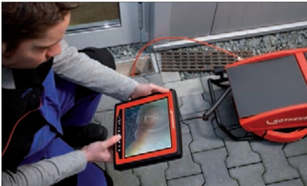
ROCAM® 3 Multimedia со съемной панелью управления
