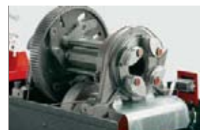
SUPER GRIP система зажимания трубы
