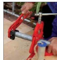
Обработка края резьбы
