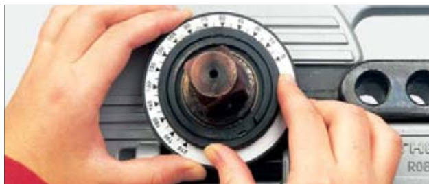
Предварительная установка угла гибки без использования инструмента
