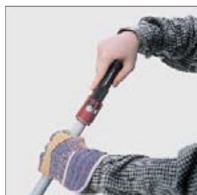
Простое снятие грата с использованием рукоятки
