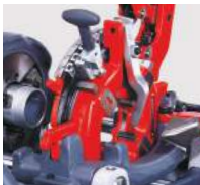
Ручная резьбонарезная головка со встроенной подачей масла
