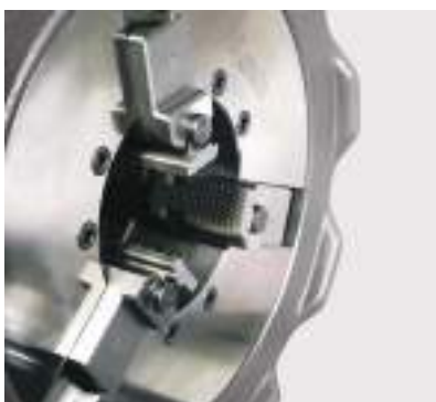
Зажимной патрон ударного действия со сменными плавающими широкими губками, надёжная фиксация за счёт подвижной подгонки и широкой опорной поверхности
