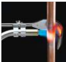
Использование с рефлектором пламени
