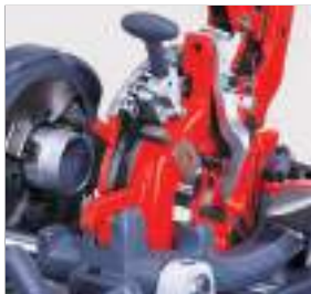
Ручная резьбонарезная головка со встроенной подачей масла
