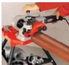
Применение устройства для накатки желобков ROGROOVER
