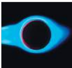
Высокая температура пламени благодаря циклонному завихрению
