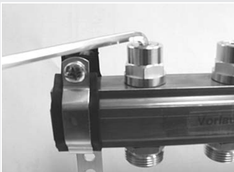
Der erforderliche Durchfluss wird mittels 5 mm Innensechskantschlüssel in Abhängigkeit des beigefügten Diagramms an der Regulierverschraubung im Vorlaufstamm eingestellt und mit einem 6 mm Innensechskantschlüssel fixiert.
