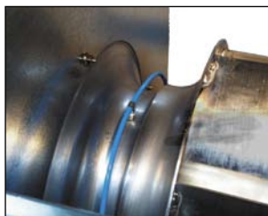
Свободно вращающееся колесо в стандартном исполнении выполняется с измерителем воздухопроизводительности
