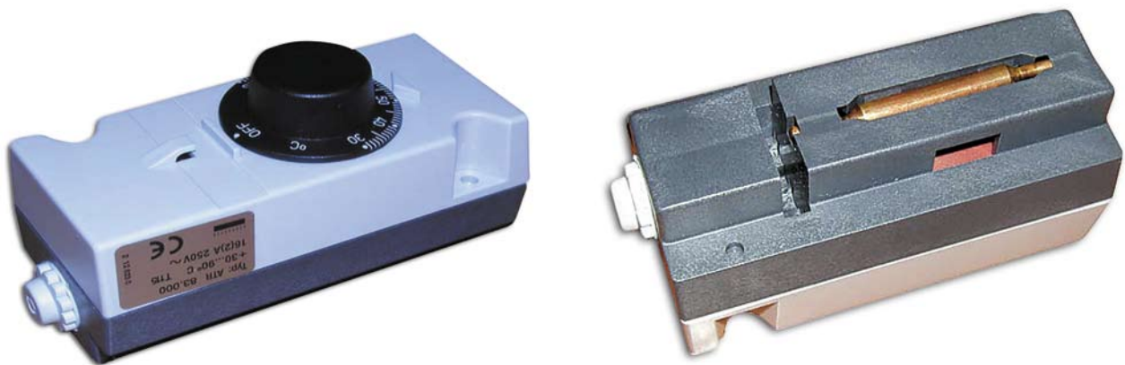
Рис. 4.25. Накладной термостат защиты от замораживания воздухонагревателя по температуре обратной воды (H40-00016)
