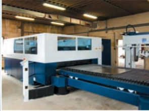
Разделение листового металла при помощи лазера
