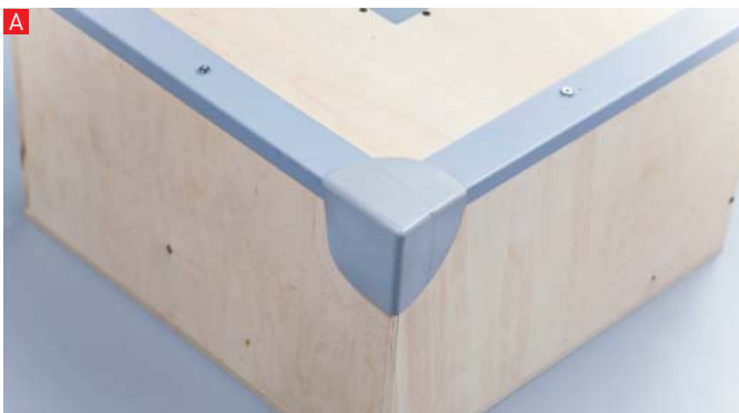
А. Для изоляции внешнего угла парапета со стороны фасада из ламинированной ПВХ-жести нарезается полоса необходимой ширины, формируется в профиль нужной конфигурации (капельник), сгибается под прямым углом по длине профиля и механически закрепляется на внешнем углу парапета.
