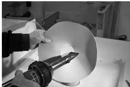
Рисунок 3.2. Ручным феном разогревают внутреннюю окружность кольца на ширину сопла 40 мм, растягивают вручную.
