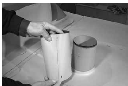
Рисунок 3.6. И сваривают по отметкам в трубку, причем в нижней части диаметр трубки увеличивают, смещая мембрану от риски на расстояние около 1 см.
