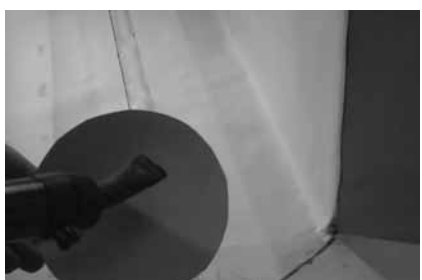
Рисунок 1.13. Для этого вырезают из неармированной мембраны круг диаметром около 150 мм, разогревают в нем сектор площадью около 1/6 круга.
