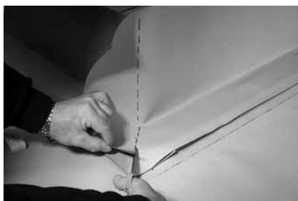
Рисунок 1.9. И, наконец, проваривают горизонтальные поверхности.
