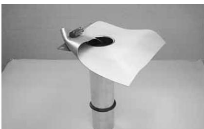
Рисунок 6.1. Для изоляции кровли в местах примыкания к водоприемным трубам устанавливают специальные водосливные воронки с фартуком из ПВХ-мембраны ROCKmembrane. Для надежной изоляции применяют герметизирующие кольца.
