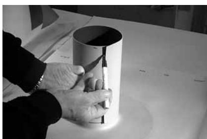
Рисунок 3.5. Полоску мембраны примеряют на трубе, отмечают рисками положение свернутой на трубе мембраны.
