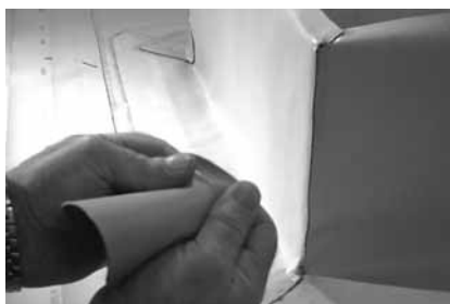
Рисунок 1.14. Растягивают нагретый участок вручную.
