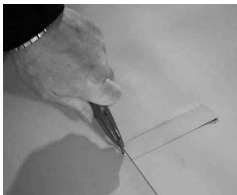
Рисунок 15. Вырезка образцов для испытания шва
