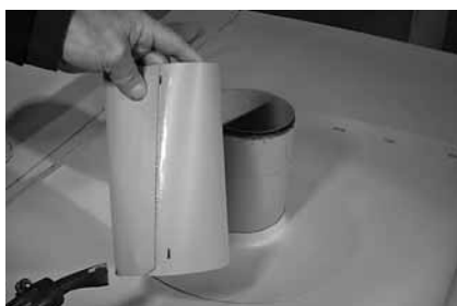
Рисунок 3.7. Торец мембраны сваренной трубки разогревают горячим воздухом.
