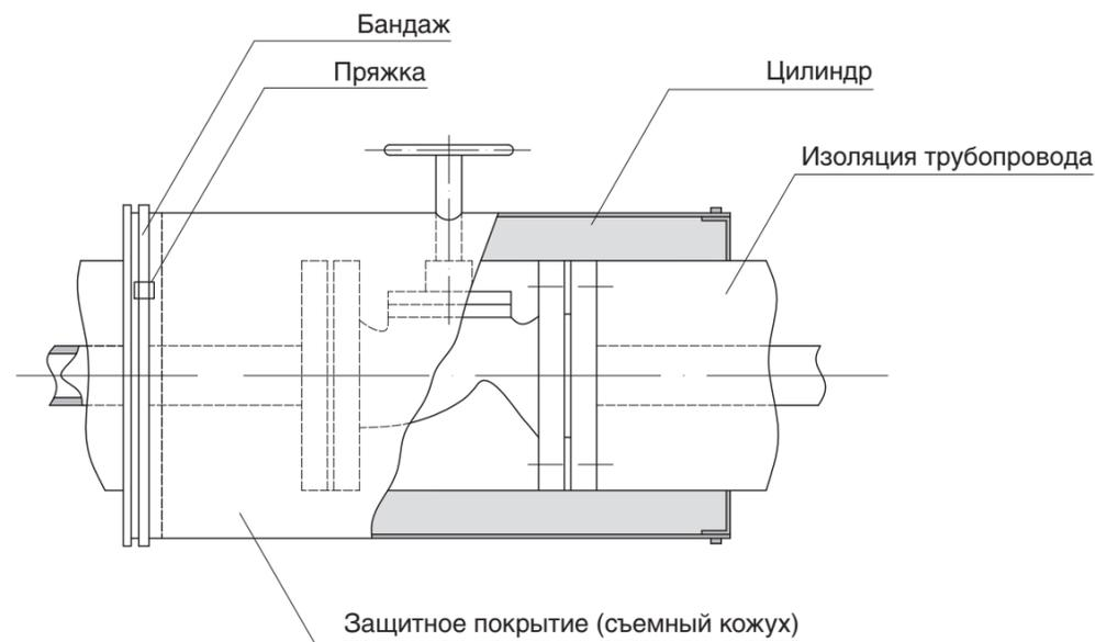
**Рисунок 2.** Тепловая изоляция арматуры фланцевой цилиндрами.
