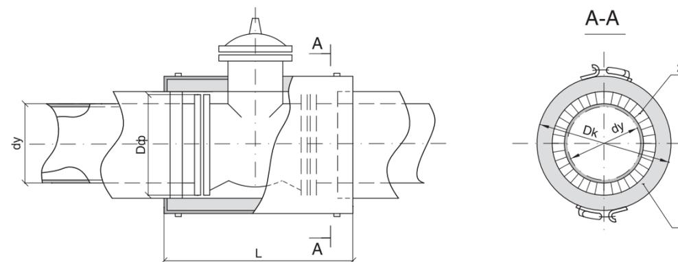
1. Полуфутляр (металлический кожух) с вкладышем-матрацем из матов теплоизоляционных Rockwool Tex Mat в стеклоткани
