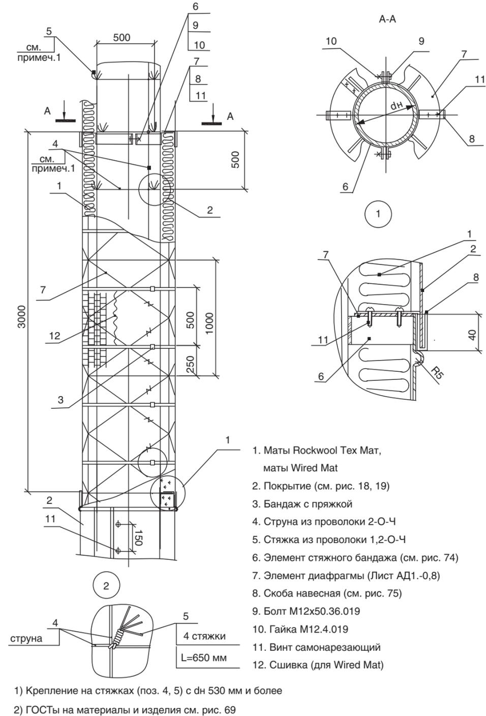
**Рисунок 10.** Изоляция вертикальных трубопроводов наружным диаметром 219 мм и более матами Rockwool Tex Mat, Wired Mat в один слой с креплением бандажками и стяжками.
