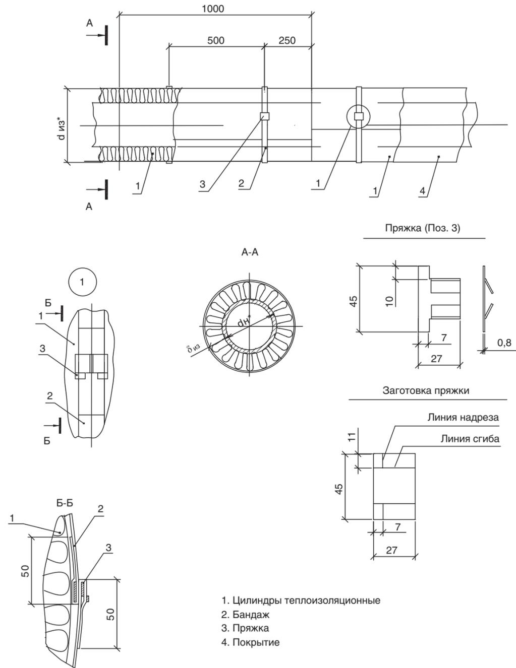
Рисунок 1. Изоляция горизонтальных трубопроводов с положительными температурами цилиндрами.
