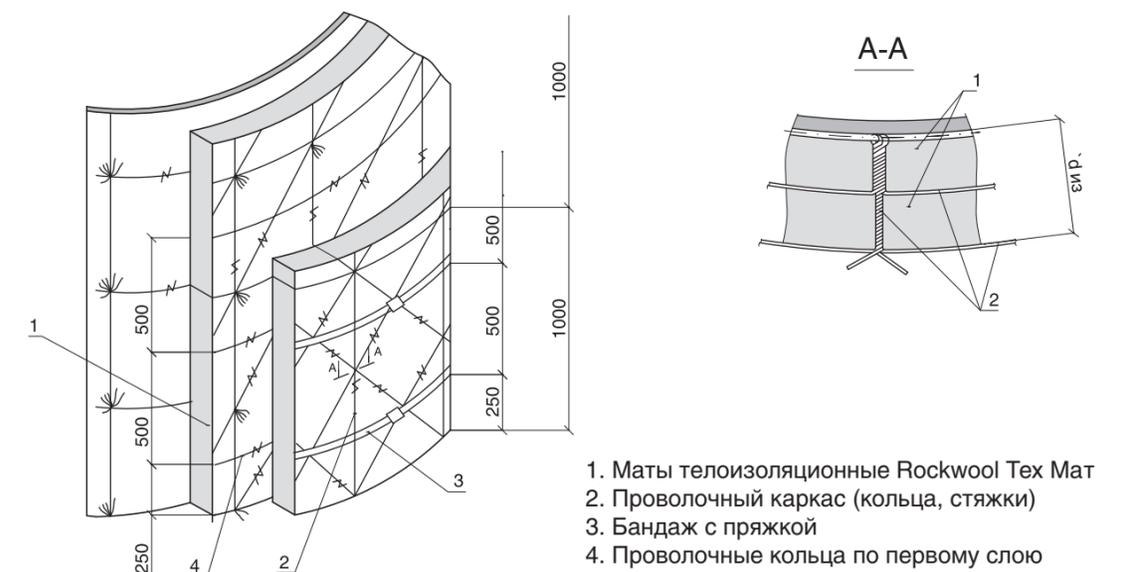
**Рисунок 2.2.4.** Изоляция вертикальных аппаратов теплоизоляционными матами Rockwool Tex Mat в два слоя с креплением на проволочном каркасе.
