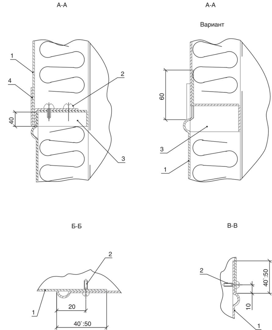
Сопряжение элементов покрытия из металлических листов
