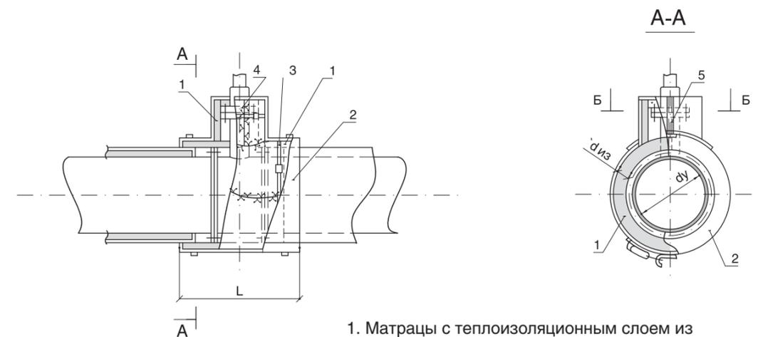
1. Матрацы с теплоизоляционным слоем из матов теплоизоляционных Rockwool Tex Mat в стеклоткани (рис. 18)
