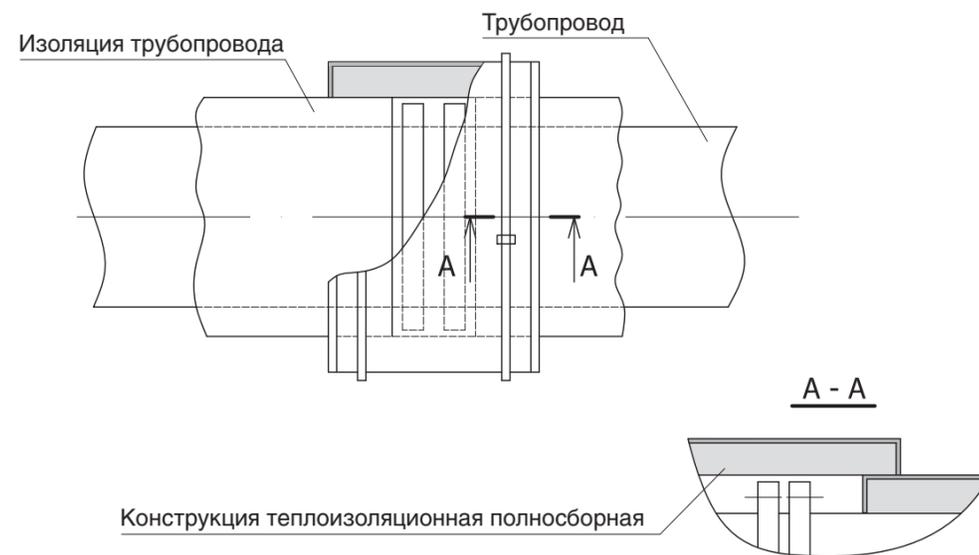
**Рисунок 3.** Тепловая изоляция фланцевого соединения конструкцией теплоизоляционной полносборной с теплоизоляционным слоем из цилиндров.
