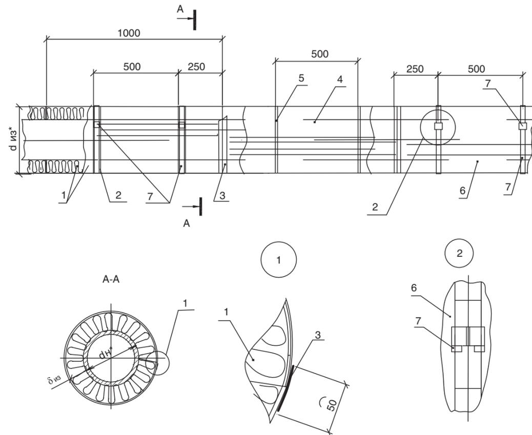
1. Цилиндры теплоизоляционные, кашированные фольгой
