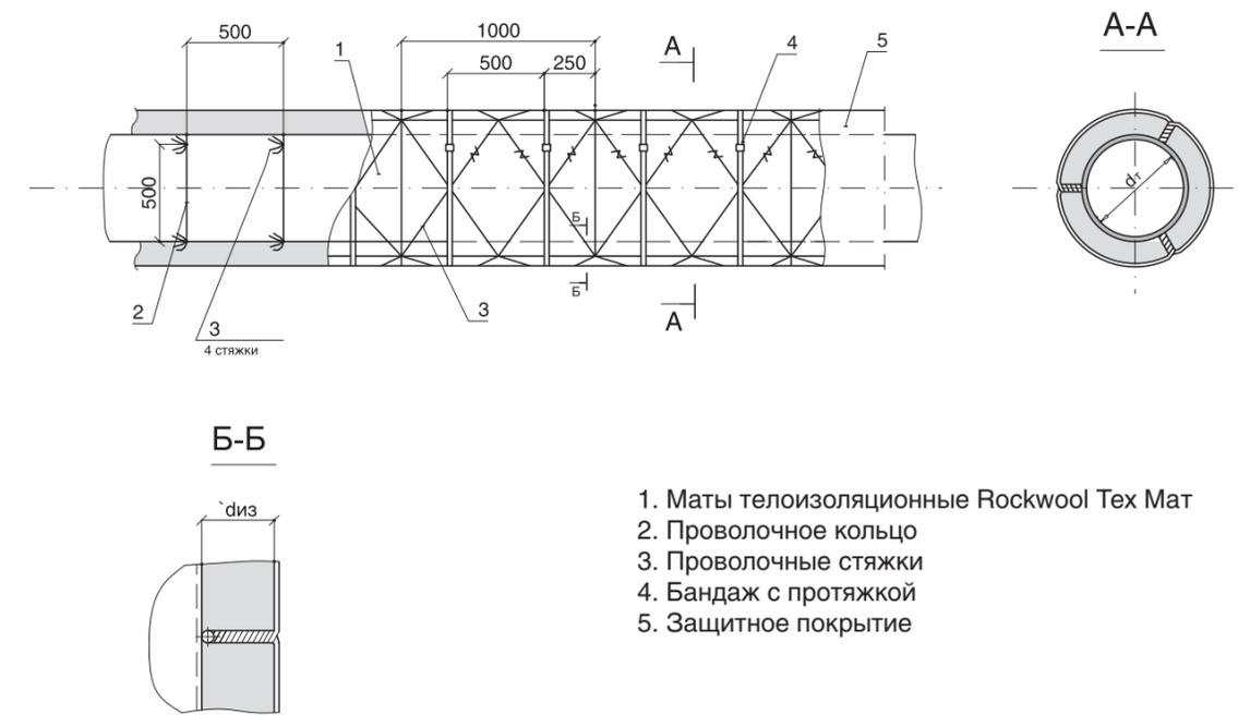
**Рисунок 2.1.4.** Изоляция трубопроводов теплоизоляционными матами Rockwool Tex Mat в один слой с креплением проволочными стяжками и бандажами.
