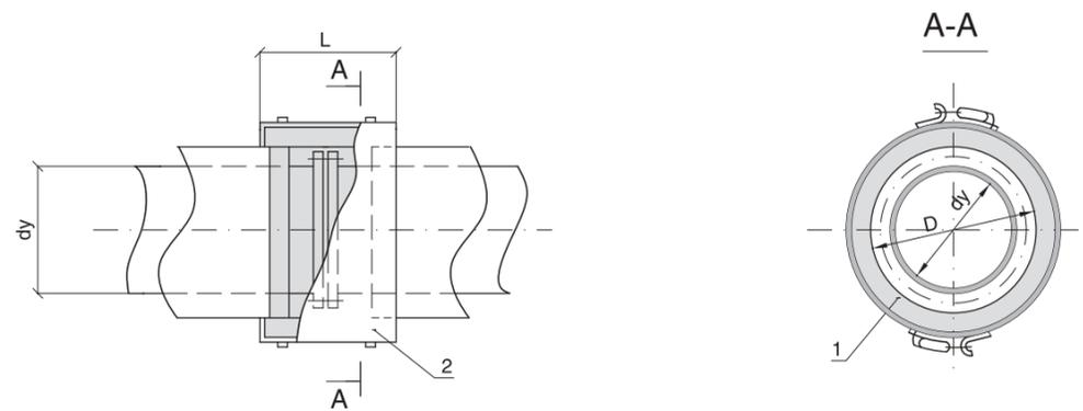
1. Матрац с теплоизоляционным слоем из матов теплоизоляционных Rockwool Tex Mat
