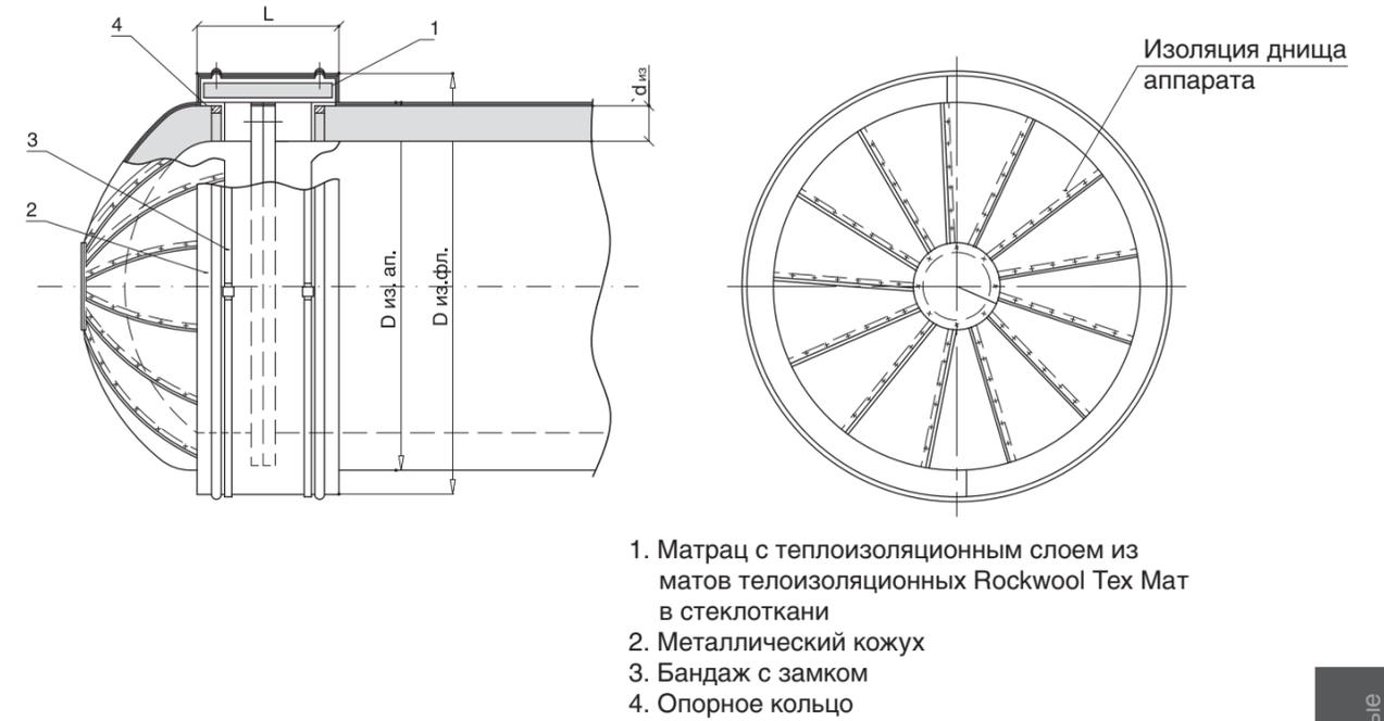
**Рисунок 2.2.15.** Изоляция фланцевого соединения горизонтального аппарата матрацами с теплоизоляционным слоем из теплоизоляционных матов Rockwool Tex Mat со съемным защитным металлическим кожухом.
