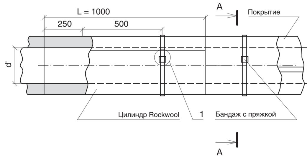
Рисунок 5. Тепловая изоляция трубопровода цилиндрами
