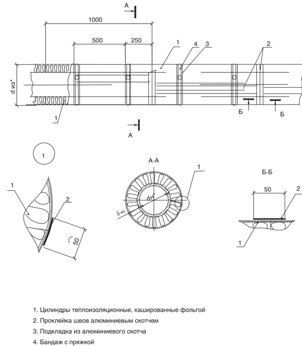
Рисунок 2. Изоляция горизонтальных трубопроводов цилиндрами, кашированными алюминиевой фольгой Ц-Кф.
