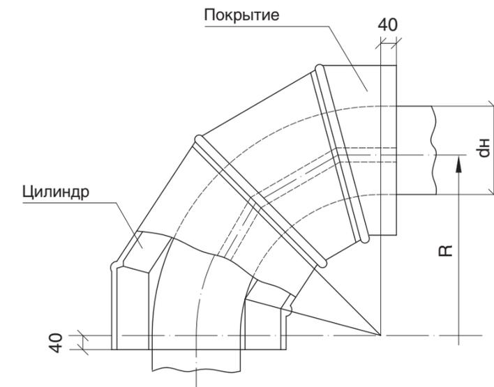
**Рисунок 4.** Изоляция отвода цилиндрами с металлическим секционным покрытием.
