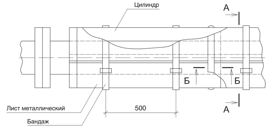
Рисунок 7. Изоляция цилиндрами. Крепление покрытия бандажами.
