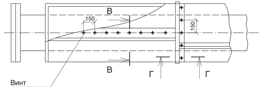
Рисунок 8. Изоляция цилиндрами. Крепление покрытия винтами.
