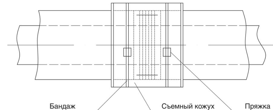
Рисунок 1. Тепловая изоляция фланцевого соединения цилиндрами со съемным кожухом.
