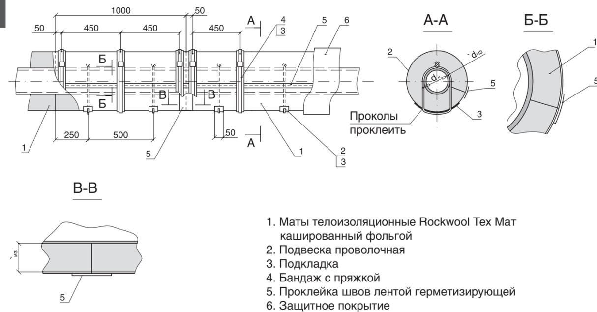
1. Маты теплоизоляционные Rockwool Tex Mat кашированный фольгой
