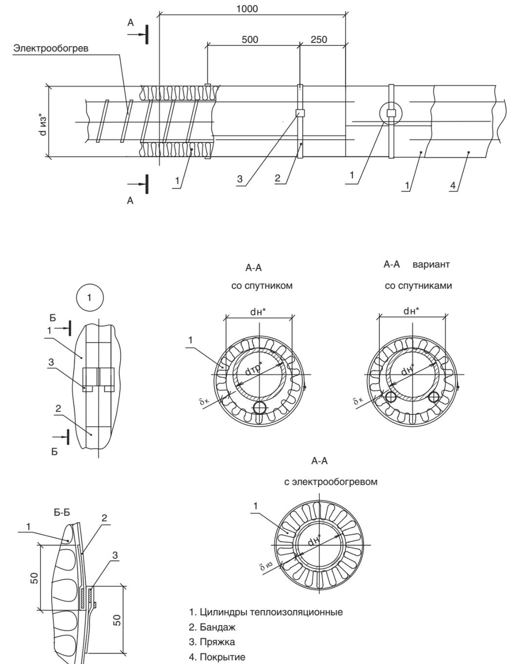
**Рисунок 4.** Изоляция горизонтальных трубопроводов со спутниками или с электрообогревом цилиндрами.
