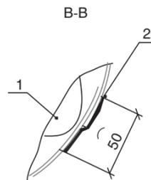
**Рисунок 21.** Изоляция трубопроводов с отрицательными температурами цилиндрами Ц-Кф, матами Rockwool Тех Мат-Кф, матами Lamella Mat с креплением металлического покрытия бандажами.
