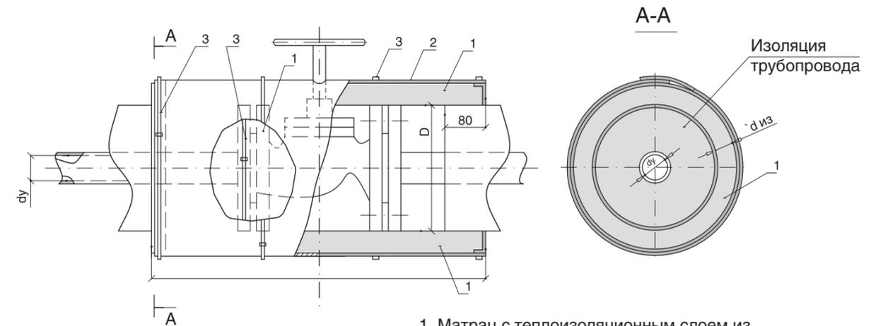
1. Матрац с теплоизоляционным слоем из матов теплоизоляционных Rockwool Tex Mat в стеклоткани
