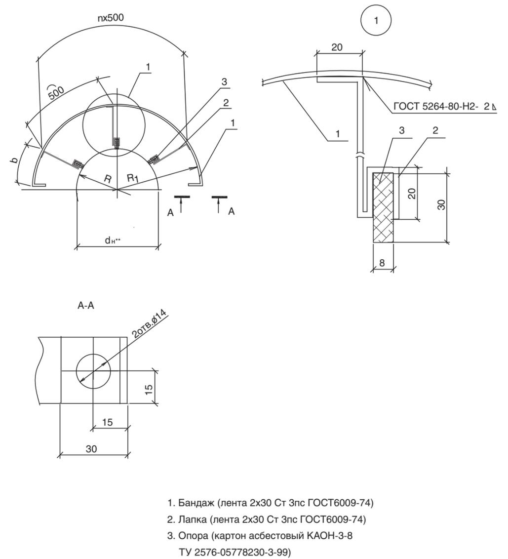
**Рисунок 72.** Элемент опорного кольца (для горизонтальных трубопроводов и аппаратов dn от 530 мм и более при толщине изоляции 100 мм и более).
