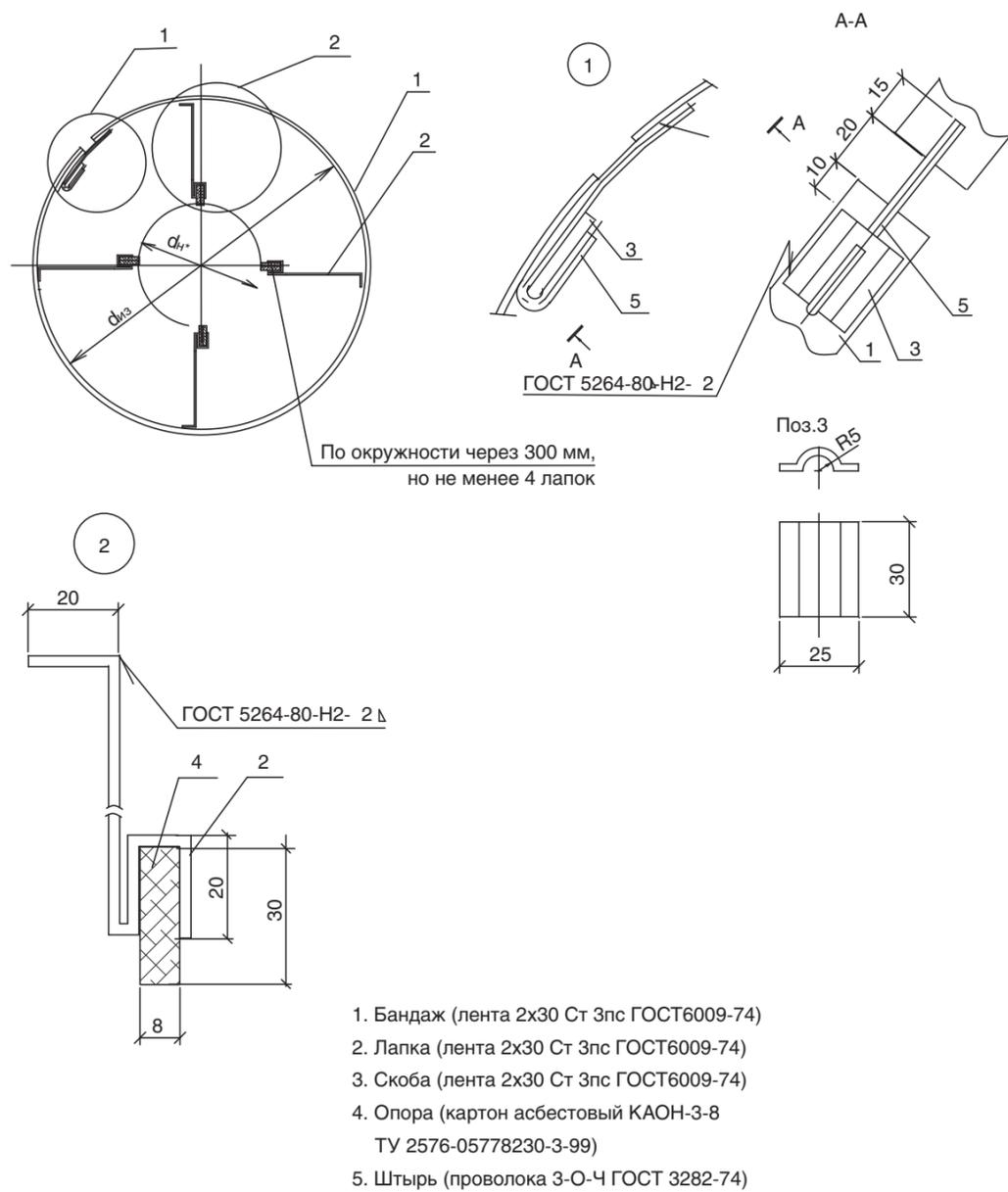
**Рисунок 71.** Кольцо опорное (для горизонтальных трубопроводов dn от 273 мм до 476 мм при толщине изоляции 100 мм и более).
