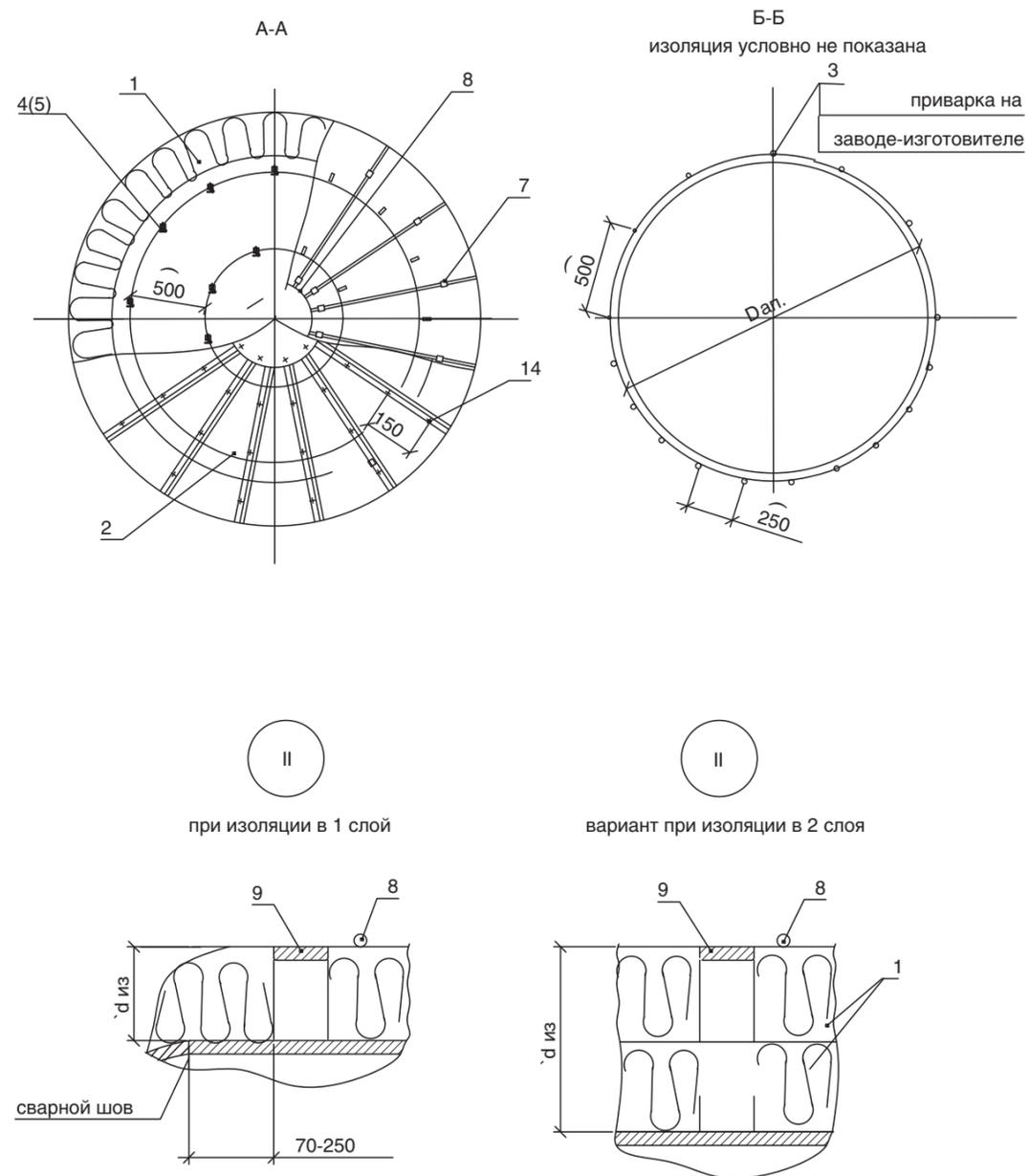
Рисунок 37. Разрезы А-А, Б-Б и узел II к рис. 36.
