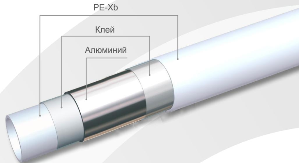
Металлополимерная труба RIIFO Omni – это высококачественная многослойная труба для систем водоснабжения и отопления, состоит из внутреннего и наружного слоев сшитого полиэтилена и алюминиевой сердцевины. Все слои надёжно соединены между собой с помощью прочных клеевых слоев, образуя единое целое. Специальная технология сварки алюминия внахлест гарантирует максимальную безопасность. Слой алюминия обеспечивает сохранение формы трубы при монтаже, предотвращает проникновение кислорода из
