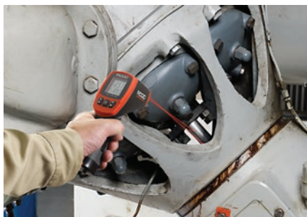
Измерение температуры изношенных деталей для планового технического обслуживания оборудования
