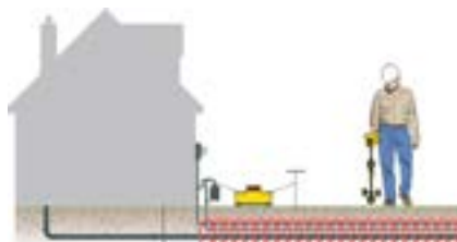
Прямое подключение к инженерным сетям.
