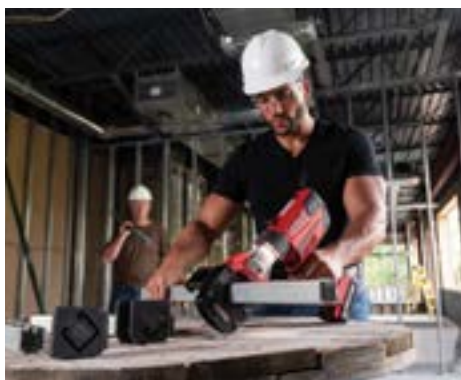
Насадка Strutslayr с пресс-пистолетом RIDGID RP 350-B
