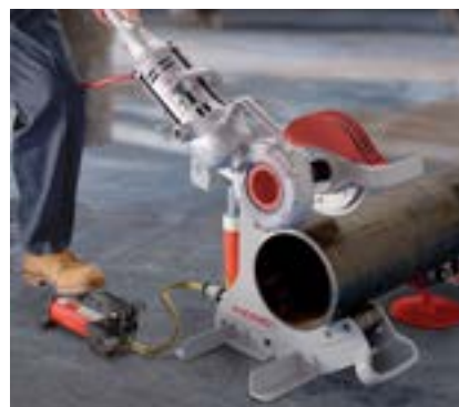
Труборез модели 258 с силовым приводом № 700 в процессе резки
