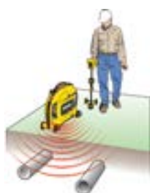
Подача сигнала для определения местоположения инженерных сетей.
