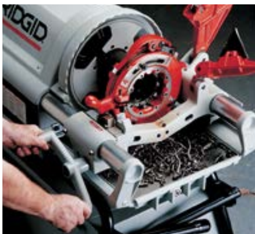
Резьбонарезная голова со ступенчатой регулировкой модели 714 (914).
