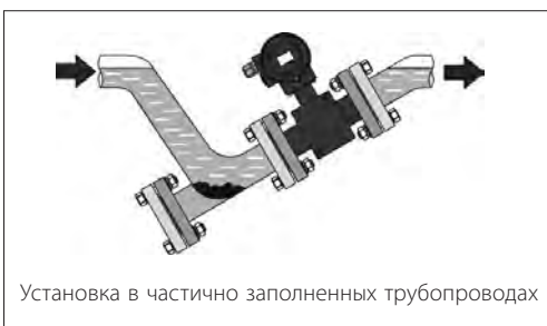
Расходомер устанавливается электронным блоком ВВЕРХ
