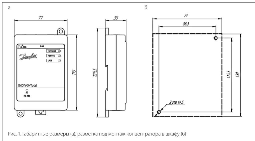
Рис. 1. Габаритные размеры (а), разметка под монтаж концентратора в шкафу (б)
