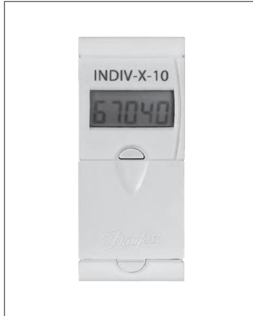
Распределитель INDIV-X-10 производит измерение и интегрирование по времени температурного напора между поверхностью отопительного прибора и воздухом в отапливаемом помещении. Результаты измерений используются для распределения потребления теплоты, зарегистрированного общедомовым прибором учета, между индивидуальными потребителями. На основе рассчитанных таким образом индивидуальных величин потребления производится начисление оплат за отопление для каждого потребителя.
