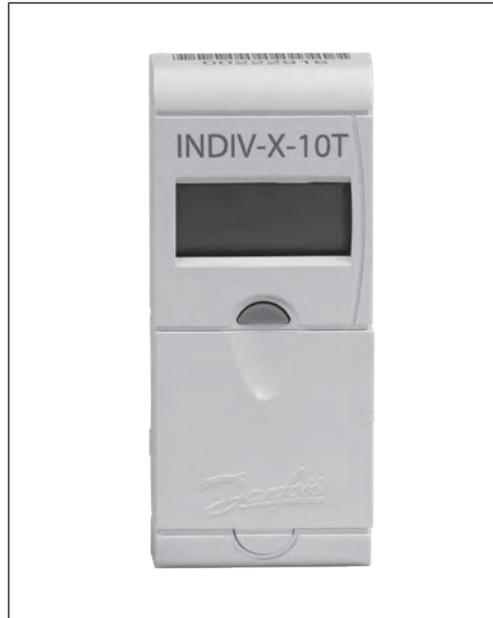
Распределитель тепловой энергии INDIV-X-10T производит измерение и интегрирование по времени температурного напора между поверхностью отопительного прибора и воздухом в отапливаемом помещении. Результаты измерений используются для распределения потребления теплоты, зарегистрированного общедомовым прибором учета, между индивидуальными потребителями.
