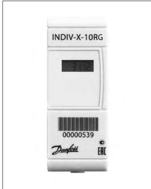
Распределитель INDIV-X-10RG производит измерение и интегрирование по времени температурного напора между поверхностью отопительного прибора и воздухом в отапливаемом помещении. Результаты измерений используются для распределения потребления теплоты, зарегистрированного общедомовым прибором учета, между индивидуальными потребителями. На основе рассчитанных таким образом индивидуальных величин потребления производится начисление оплат за отопление каждого потребителя.
