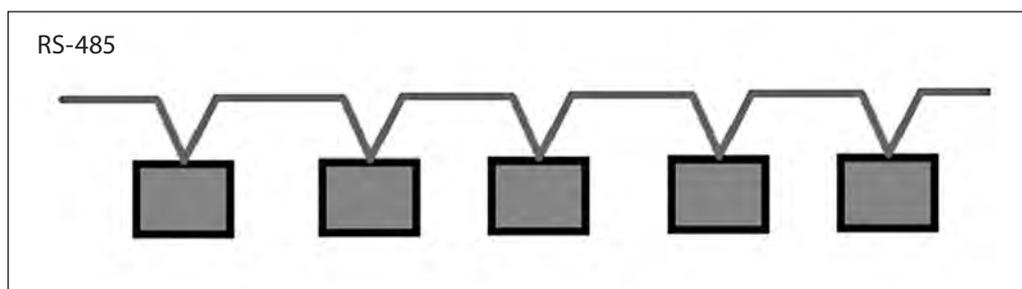
Для шины RS-485 используется специализированный экранированный кабель. Защитный экран должен быть соединен на всем протяжении шины и заземлен с одного конца. С другого конца экран изолируется.
