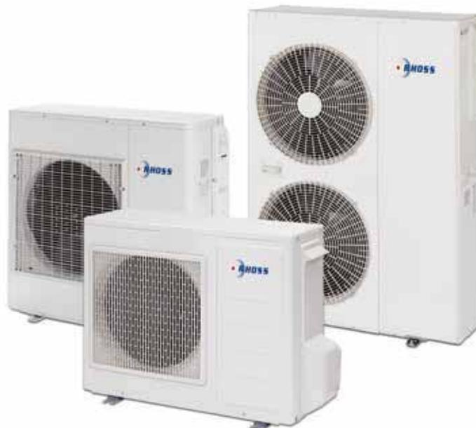
Реверсивные тепловые компактные насосы с воздушной конденсацией и осевыми вентиляторами. Серия герметичных ротационных компрессоров прямого тока, с инвертором, заправленных хладагентом R410A.
