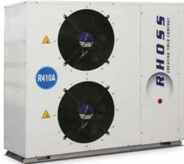
Водные охладители и реверсивные тепловые компактные насосы с воздушной конденсацией и осевыми вентиляторами. Серия спиральных герметичных компрессоров DC с инвертором и газовым хладагентом R410A.
