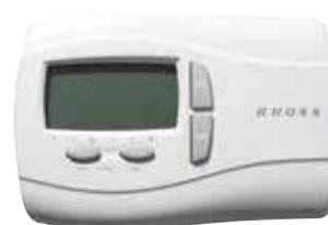
Комплектующее КСТР - Хронотермостат, устанавливаемый внутри помещения для управления температурой и расписанием для максимального комфорта и минимального потребления электроэнергии. Позволяет также активировать основные состояния и рабочие режимы теплового насоса и отобразить основные данные управления, установленные на оборудовании.
