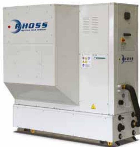
Водные охладители и реверсивные тепловые компактные насосы с воздушной конденсацией и вентиляторами Plug-Fan с ЕС-двигателем. Серия спиральных герметичных компрессоров DC с инвертором и газовым хладагентом R410A.
