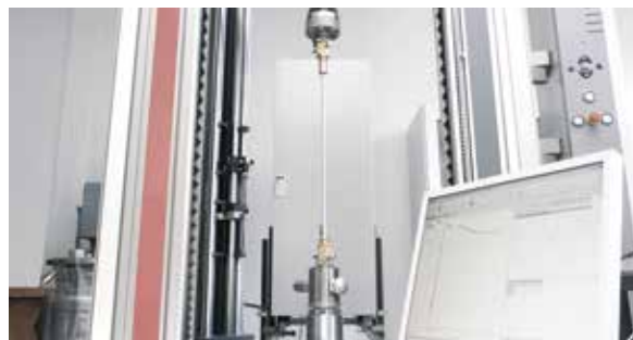
Рис. 3 Ход испытания на растяжение
