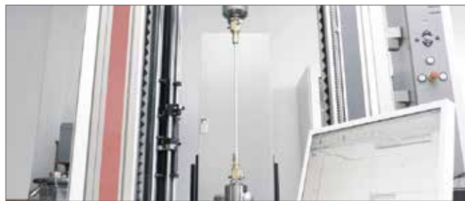
Рис. 2-3 Ход испытания на растяжение
