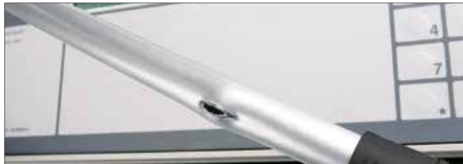
Рис. 2-1 Результаты испытания прочности на разрыв давлением. Испытуемый продукт – универсальная труба RAUTITAN flex
