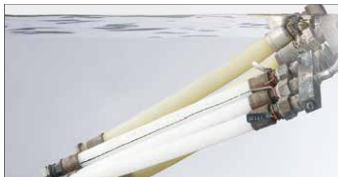
Рис. 2-4 Трубы в момент длительного испытания (под давлением в водном резервуаре)
