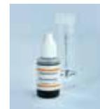
Комплект для измерения общей степени жесткости позволяет определять и контролировать жесткость воды, поступающей из водопровода на подпитку.
