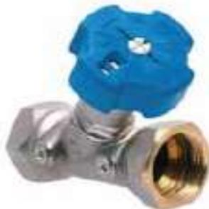
Резьбовой балансировочный клапан Balanflow Резьбовой, оснащен ручкой с индикатором количества оборотов, функция остановки по команде памяти для блокировки тарированной позиции, подготовлен для вставки штуцеров замера давления для замера пропускной способности.
