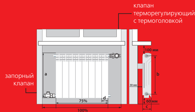
РИС. 2. РЕКОМЕНДУЕМЫЕ СХЕМЫ ПОДКЛЮЧЕНИЯ РАДИАТОРА К СИСТЕМЕ ОТОПЛЕНИЯ
