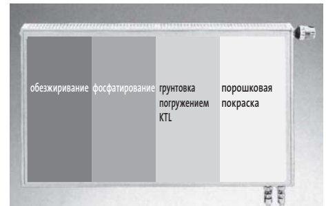
Обработка поверхности радиатора
