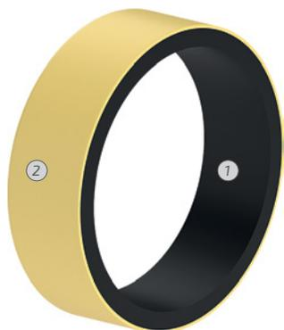
1. Несущий слой напорной трубы из ПЭ 100 или ПЭ 100-RC. Толщина зависит от номинального давления (PN). По согласованию с Заказчиком возможно изготовление данного слоя из PE-RT тип II для применения при повышенной температуре транспортируемой среды.
